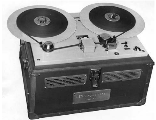
Das Nur-Wiedergabegerät Magnetophon K 5, Laufwerk. Die Mechanik entspricht weitgehend der des Magnetophon K 4. Der kleine Abschirmgehäuse (vorn Mitte) verdeckt den Wiedergabe-Magnetkopf. Die Begleitpapiere bezeichnen dieses Exemplar als „Führergerät“.
