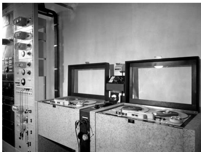
Magnetofonanlage R 122 (so die RRG-Bezeichnung). Verstärker und Netzgeräte für die beiden Laufwerke R 22 sind in dem Verstärkergestell links im Bild eingebaut.
